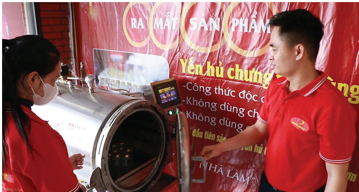
Anh Lu Hải Vinh kiểm tra thông số nhiệt độ, áp suất của thiết bị trước khi chưng mẻ yến sào mới
